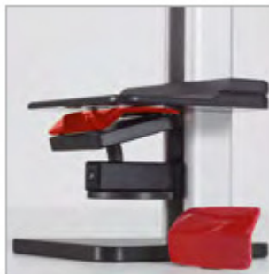
Elastyczna podstawka na próbki ułatwia orientację elementów posiadających krzywizny
